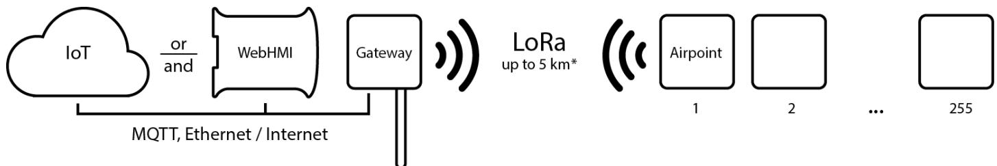
Основной особенностью такой концепции, является продолжительная автономная работа модулей телеметрии (более 1 года, или порядка 50 000 пакетов, от одного комплекта батарей), с возможностью передачи данных на расстояние до нескольких километров на открытой местности и до 1000 метров в условиях городской застройки\*
