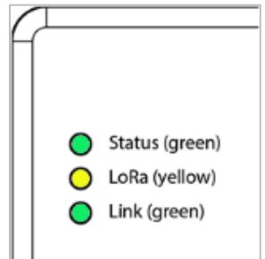
Если светодиод Status не показывает наличие подключения к брокеру, в первую очередь следует проверить еще раз настройки, физическую связь между шлюзом интернет и Airgate (есть ли MAC-адрес AirGate в арендах DHCP, отрабатывает ли команда `ping` на сетевой адрес AirGate)
