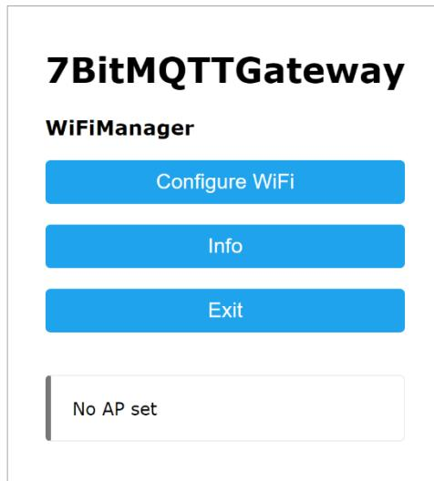
Для конфигурирования шлюза перейдите на стр. Configure WiFi. Для подключения AirGate к интернет по **WiFi** используйте список найденных сетей. При выборе нужной сети ее имя подставится в поле SSID. При необходимости укажите пароль для доступа к этой сети.
